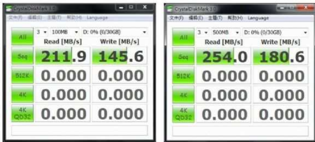
圖說：IS888 搭配 Intel X25-E SSD 使用 AI-Turbo 的測試結果，左圖未安裝 AI-Turbo，右圖已安裝 AI-Turbo。
